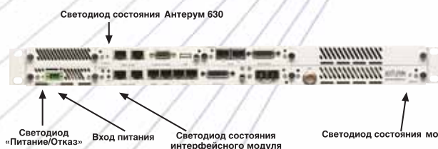
Рисунок 2. Передняя панель внутреннего блока Антерум 630 конфигурации 1+0. Светодиоды состояния.
